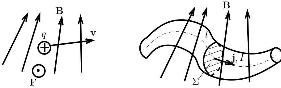
Obrázek 3.1: Lorentzova síla působící na pohybující se náboj (vlevo) a na proudovodič (vpravo).
