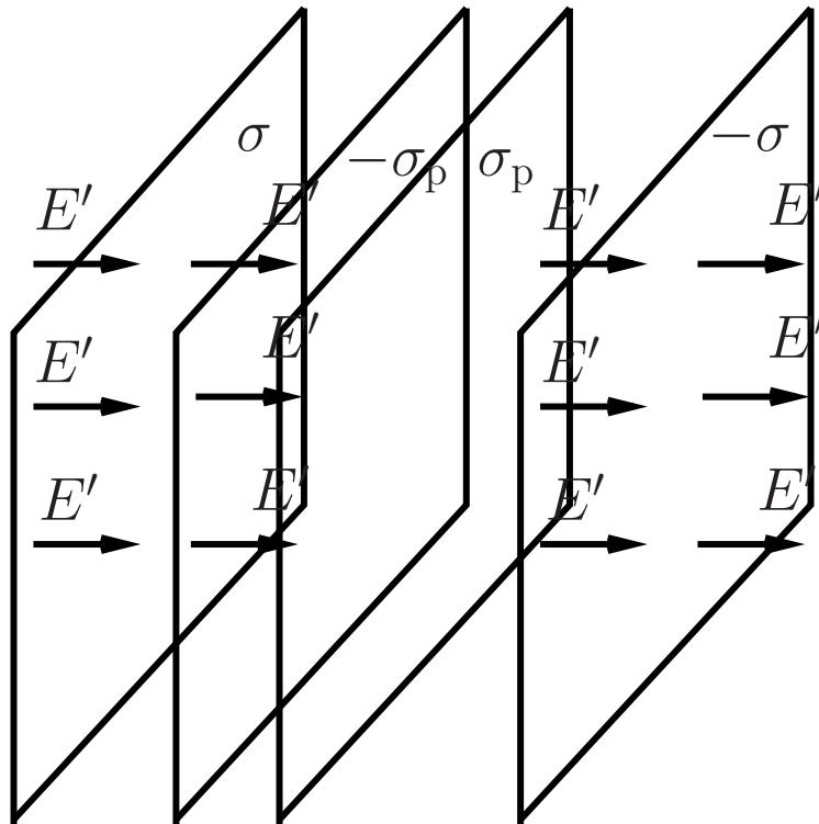
Příklad modeluje chování polarizovaných nábojů (vnitřní kondenzátor) v dielektriku, které je vloženo do elektrostatického pole (vnější kondenzátor).
