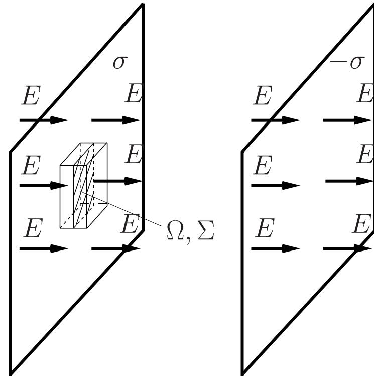
Příklad 3: Pole deskového kondenzátoru
