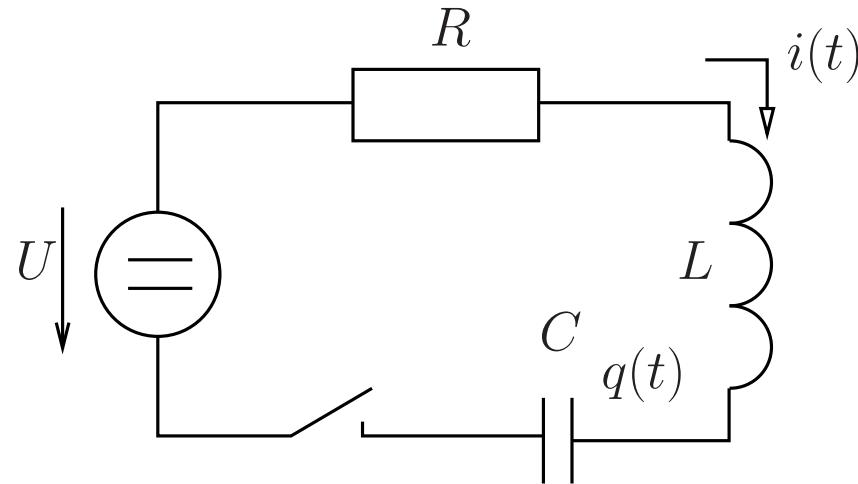
Průběh proudu  $i(t)$  a náboje  $q(t)$  po připojení stejnosměrného zdroje k sériovému RLC obvodu lze popsát následující soustavou obyčejných diferenciálních rovnic prvního řádu:
