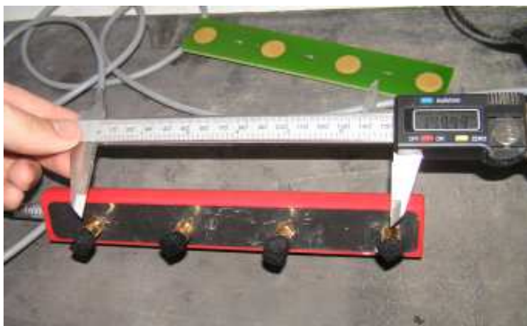
Obr. 29: Elektrody Wennerovy sondy opatřené kontaktními černými houbičkami.
