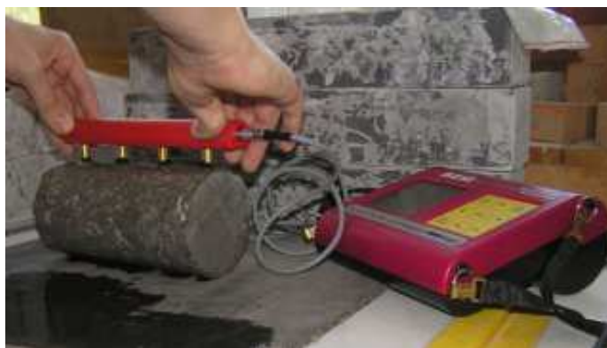
Obr. 28: Postup měření povrchové difuze za pomoci Wennerovy sondy Resi.
