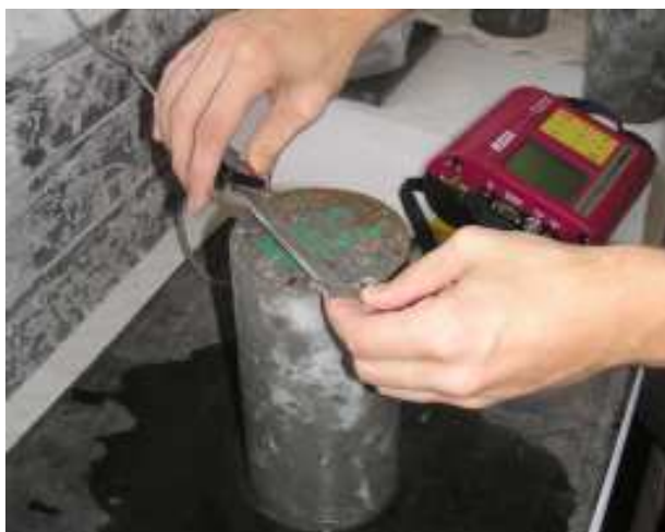
Obr. 15: Měření rozměrů nově vybetonovaného vzorku předcházejí zkoušce resistivity.
