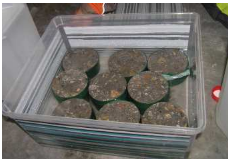
Obr. 18: Vzorky ponořené v lázni a opatřené epoxidovým povlakem
