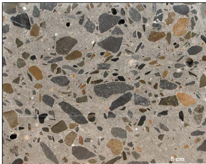
Obr. 7. Dobře zhutněný beton s malým množstvím vzduchových pórů
