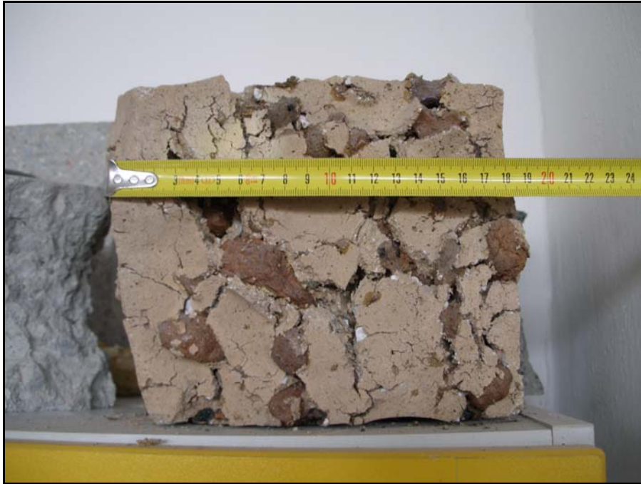
Obr.8. Podoba krychle, vyrobené z prostého cementového betonu, původních rozměrů 150x150x150mm, po výpalu na 1200°C
