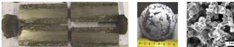
Obr. 1. Dôsledok cloggingu pri odlievaní IF akostí ocelí a detail identifikovaných inklúzií
