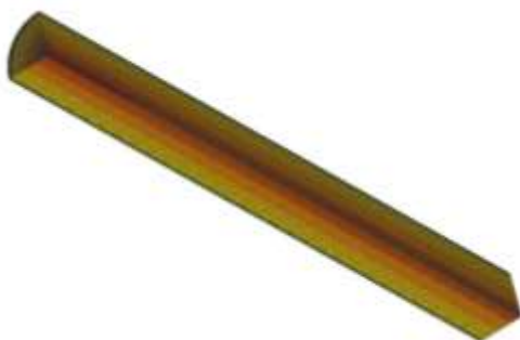
Obr. 4 Geometrie plynule litého předlitku kul. 130 mm použitá pro výpočet predikce trhlin a prasklin
