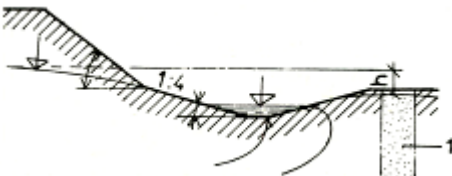
Příkop pro povrchové odvodnění v jemném písku 1-jílová stěna
