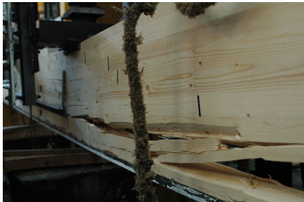
Zkouška dřevěných trámů, ČVUT, Praha
