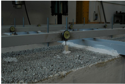
Ohybová zkouška železobetonových trámů, ČVUT, Praha
