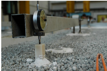
Ohybová zkouška železobetonových trámů, ČVUT, Praha
