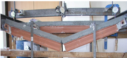
Zlomená keramická stropnice Hurdis po zatěžovací zkoušce ohybem foto: doc. Ing. Václav Cepek, CSc.
