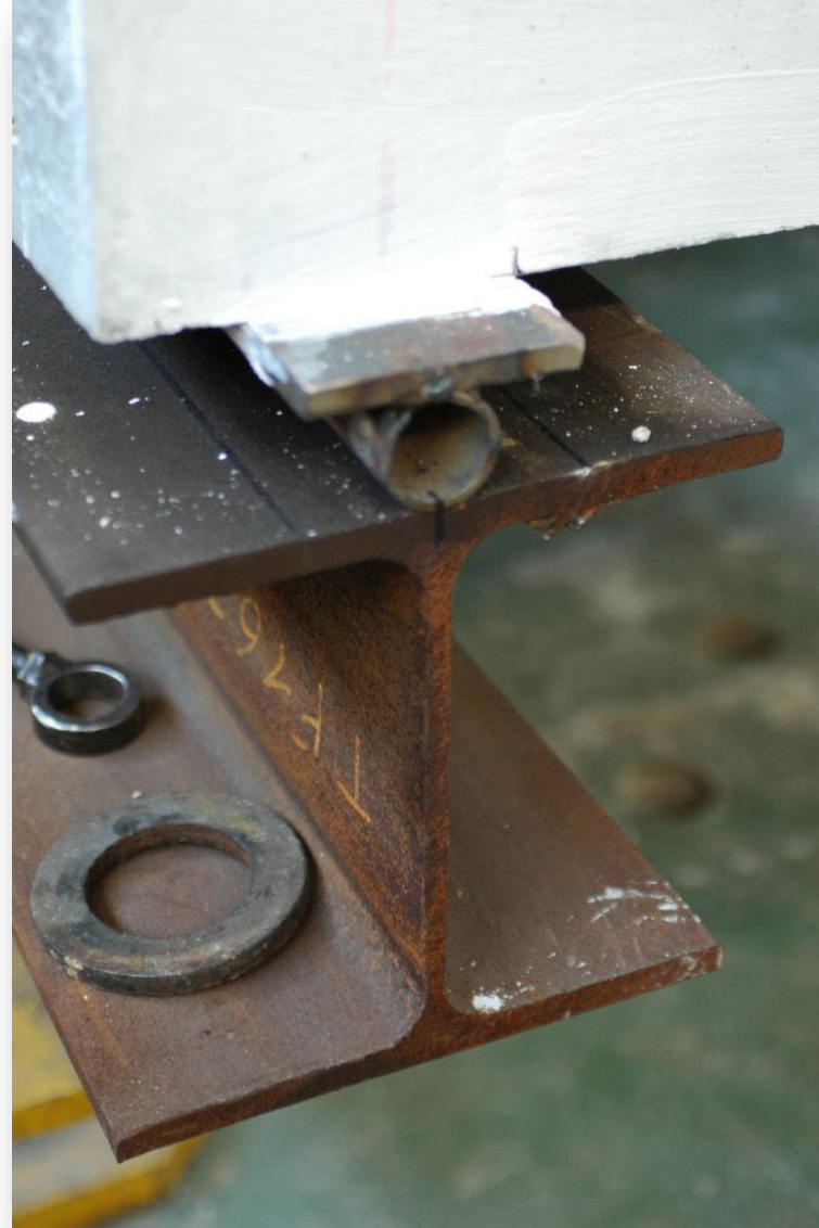
Ohybová zkouška železobetonových trámů, ČVUT, Praha
