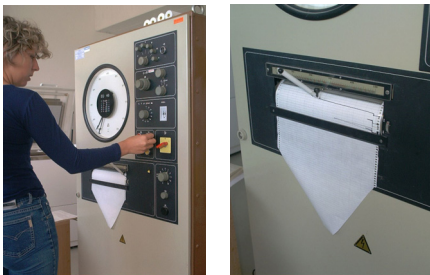
Tahová zkouška oceli, experimentální určení pracovního diagramu
