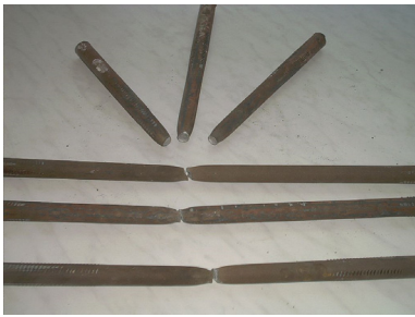
Přetržené vzorky oceli po tahové zkoušce
