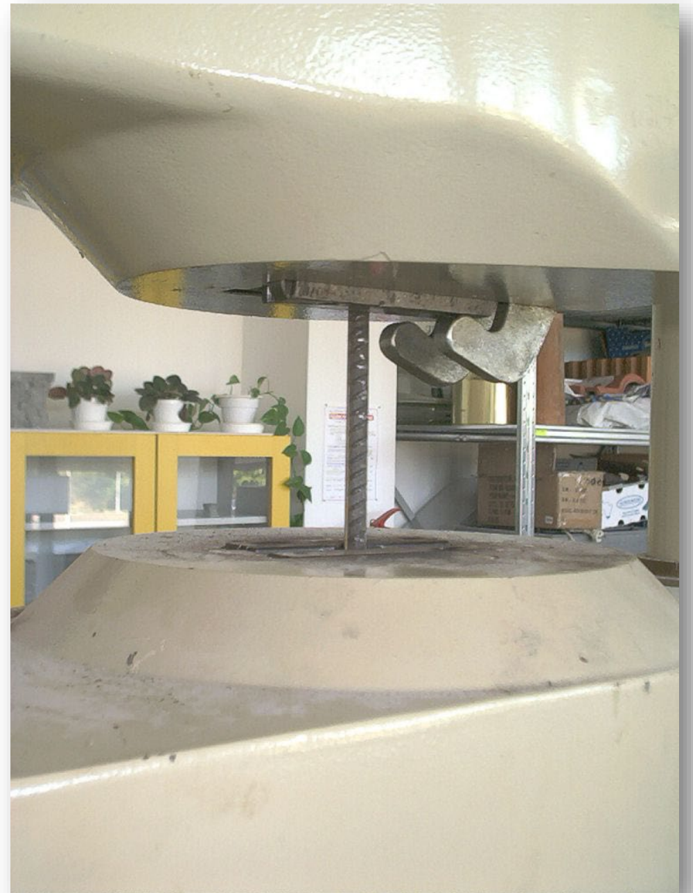
Tahová zkouška oceli
