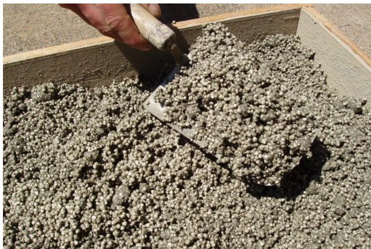
Obr. 39 Čerstvý polystyrenbeton (převzato z http://www.enroll.cz )
