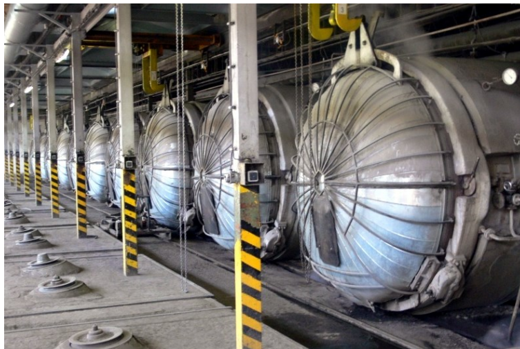
Obr. 43 Autoklávy pro vytvrzování tvárnic a příčekvek z pórobetonu (převzato z http://www.porfix.sk )
