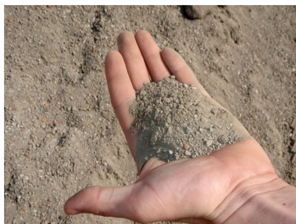
Obr. 22 Betonový recyklát frakce 0 - 8 (převzato z http://www.resta-dakon.cz )
