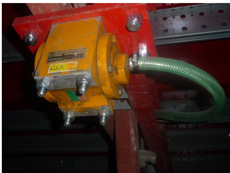
Obr. 66 Pneumatický příložný vibrátor (převzato z http://www.ulma.cz )
