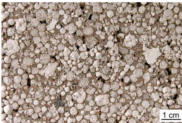
Obr. 37 Řez vzorkem polystyrenbetonu o objemové hmotnosti 500 \text{ kg.m}^{-3}
