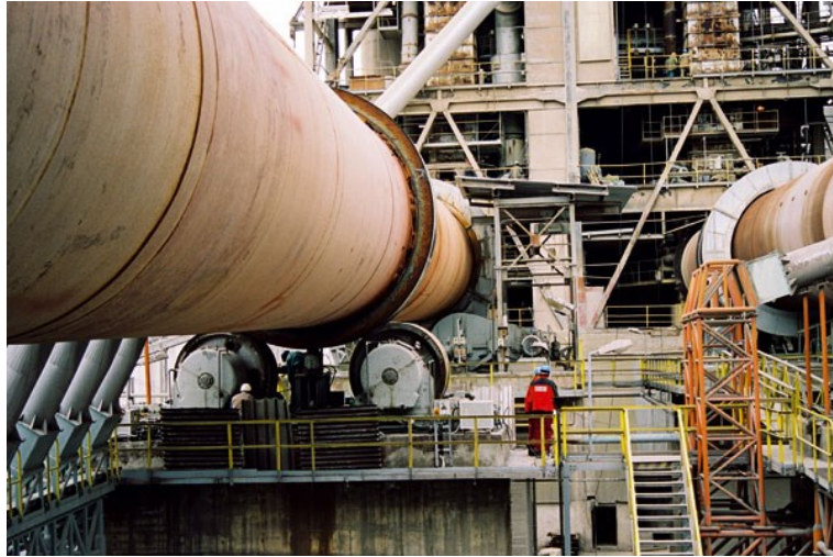
Obr. 1 Rotační pece pro výpal portlandského slínku (převzato z [29])
