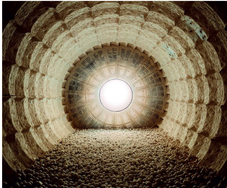
Obr. 3 Pohled do nitra cementového mlýna s ocelovými mlecími tělesy (převzato z [29])
