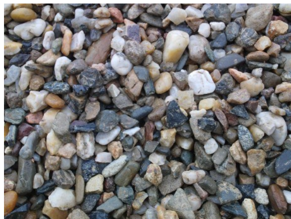
Obr. 18 Těžené hrubé kamenivo frakce 4 - 8 (převzato z http://www.betonarna-k-most.cz )
