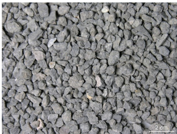
Obr. 19 Drcené hrubé čedičové kamenivo frakce 4 - 8, Bílčice
