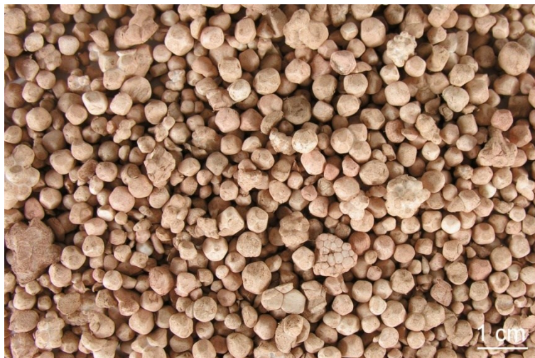
Obr. 38 Ekostyren - polystyrenové plnivo s povrchovou úpravou pro snížení lepivosti
