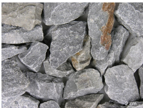
Obr. 21 Drcené hrubé drobné kamenivo frakce 16 - 32, Bohučovice
