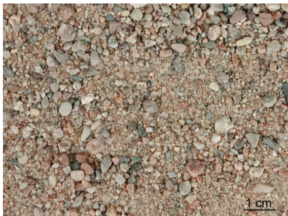
Obr. 17 Těžené drobné kamenivo frakce 0 - 4, Staré Ždánice
