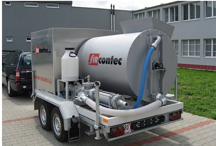
Obr. 41 Zařízení pro výrobu polystyrenbetonu a pěnobetonu (převzato z http://www.sircontec.com )
