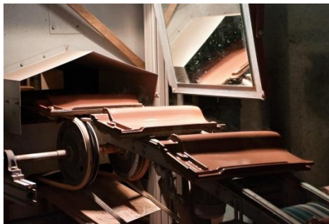
Obrázek 04: Nanášení engoby na povrch střešní krytiny
