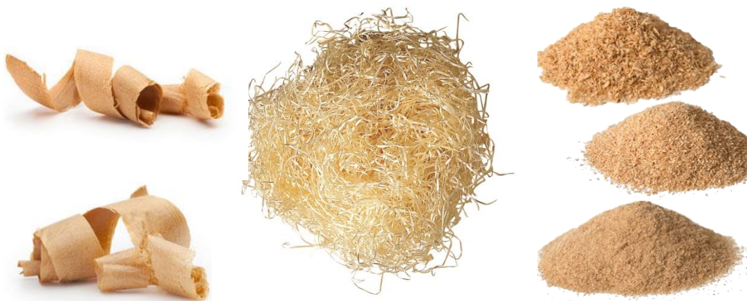
Obrázek 06: Příklady nejčastějších dřevních částí používaných pro výrobu materiálů na bázi dřeva (z vrchu a zleva): dýhy, velké ploché štěpky, štěpky, hobliny, dřevní vlna, dřevní vlákna a dřevní moučka.
