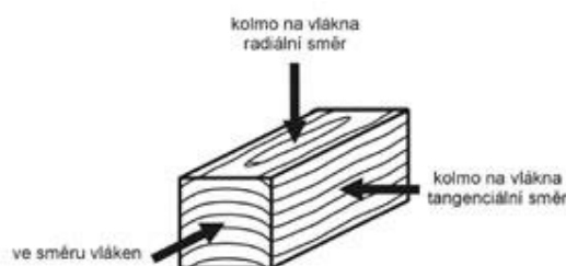
Obrázek 01: Anizotropie dřeva - směry zkoušení vlastností dřeva
