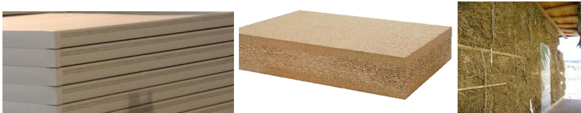
Obrázek 04: Ekopanel (Slámokarton), slámovláknitá deska a slaměné balíky v dřevěné konstrukci.
