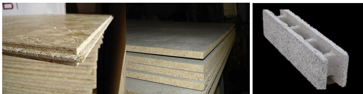
Obrázek 06: OSB desky, dřevo cementové (pazdeřo-cementové) desky a dřevocementové ztracené bednění
