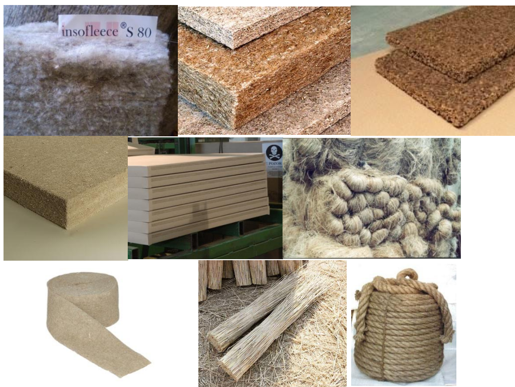
Obrázek 01: Izolace: ovčí vlna, slaměné desky, korkové desky, dřevovláknité desky, ekopanely (slámokarton), lněná koudel, konopný filc, lněný těsnicí provazec
