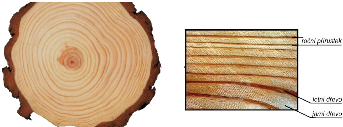
Obrázek 03: Příčný řez modřínem - letokruhy s výrazným barevným a tloušťkovým rozdílem jarního a letního dřeva.
