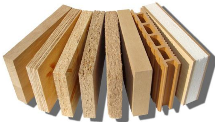
Obrázek 08: (zleva): spárovka, překližovaná deska, deska z orientovaných plochých třísek (OSB), dřevotřísková deska, izolační (měkká) vláknitá deska, vláknitá deska se střední hustotou (MDF), dřevo-plastová deska (WPC), sendvičový panel (foto převzato z http://drevene-materialy.fld.czu.cz )
