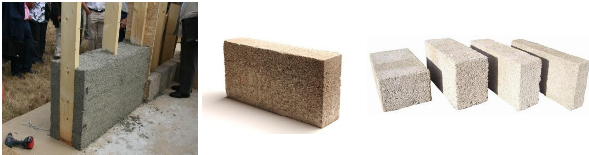
Obrázek 05: Příklad výplňové hmoty a bloku vyrobeného z konopného pazdeří pojeného vápnem s pucolány a cementem. ( Hempcrete, chanvriblock )
