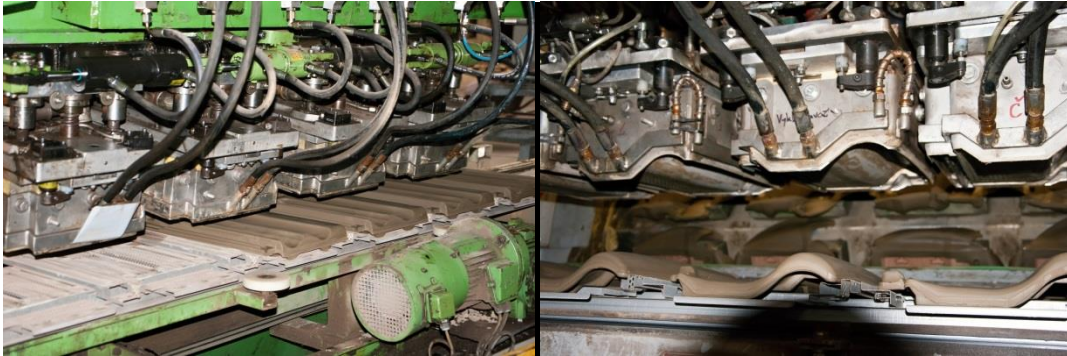
Obrázek 09: Ražení střešní krytiny, Tondach Hranice.
