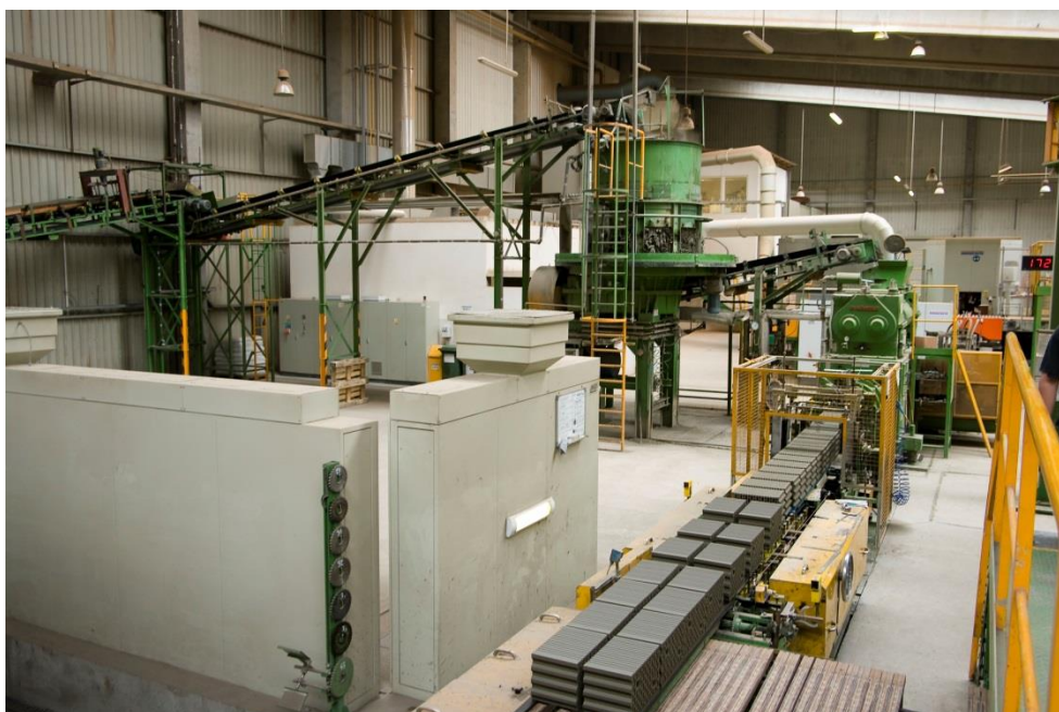
Obrázek 08: : Vytvářecí část výrobního procesu keramické tvarovky. Odzadu: protlačování keramického těsta, vytváření vakuovým šnekovým lisem, řezání strunou na jednotlivé výrobky.
