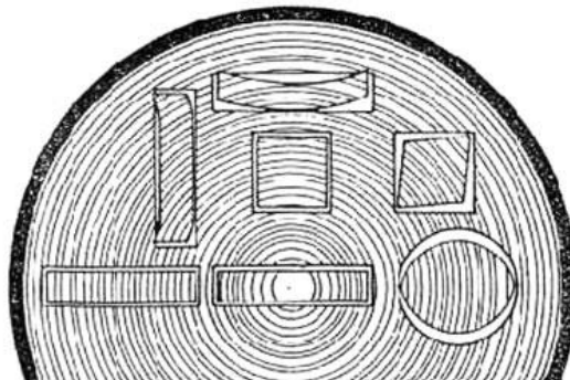
Obrázek 02: Způsoby příčného borcení dřevěného sortimentu
