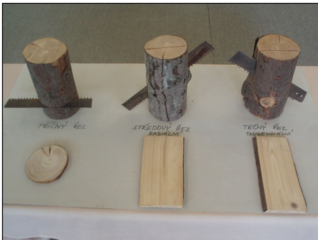
Obr.4. Pozice příčného, radiálního a tangenciálního řezu ve dřevě
